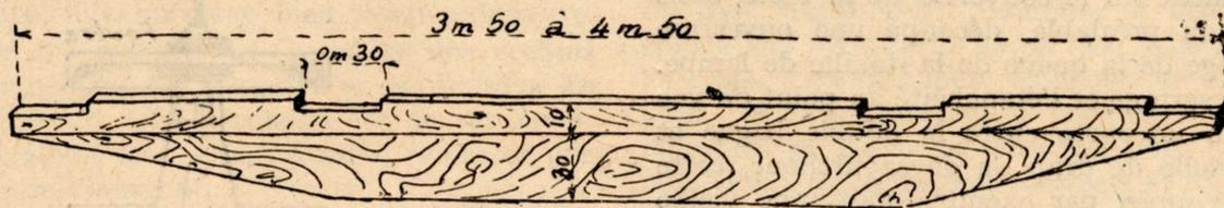
FIG. 1. — Scier dans deux planches les flancs et dresser soigneusement les tranches au rabot, ménager l'encastrement des traverses.
